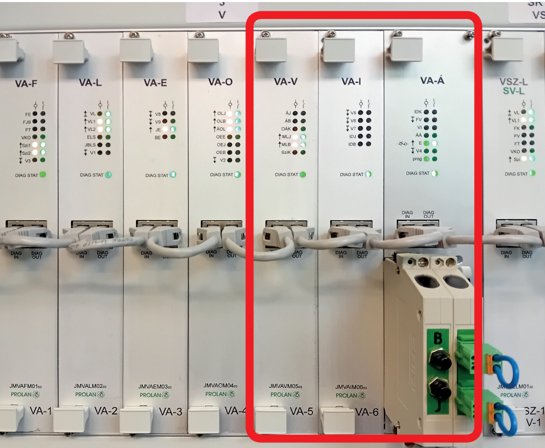
Abbildung 2: Das vollständige Weichenstellmodul, die zum reduzierten Modul notwendigen Karten sind im roten Rahmen
